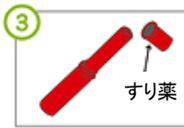
③ 先端のふたを取り、すり葉で発煙筒の先端をこすり、着火させます。
