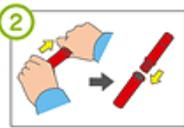
② 回しながら引き抜き、本体を逆さにして押し込みます。
