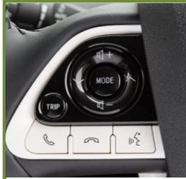
ステアリングスイッチで、ハイブリッドシステムインジケータや燃費履歴など、エコ情報画面も表示できます。
