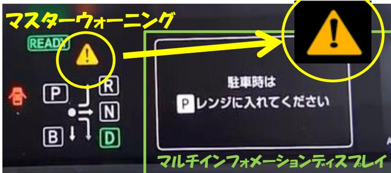
マルチインフォメーションディスプレイに警告メッセージが表示されている時に点灯、点滅します。マルチインフォメーションディスプレイの指示に従ってください。
