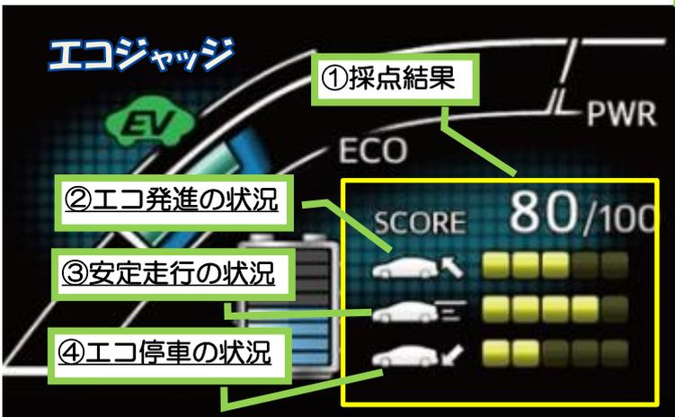
なめらかな発進加速、急な加減速のない安定した走行、スムーズな停車という3つの観点から走行状況をそれぞれ5段階で評価し、車両が停車するたびに100点満点で採点結果を表示します。
