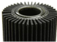
劣化した オイルフィルター
