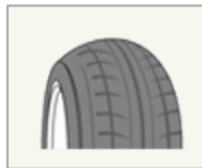
タイヤ空気圧 タイヤの溝の深さ タイヤの亀裂・損傷 タイヤの異状な摩耗
